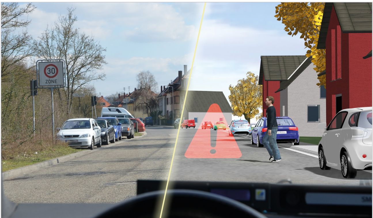
Test eines Notbremsassistenten im Vehicle-in-the-Loop-Versuch
