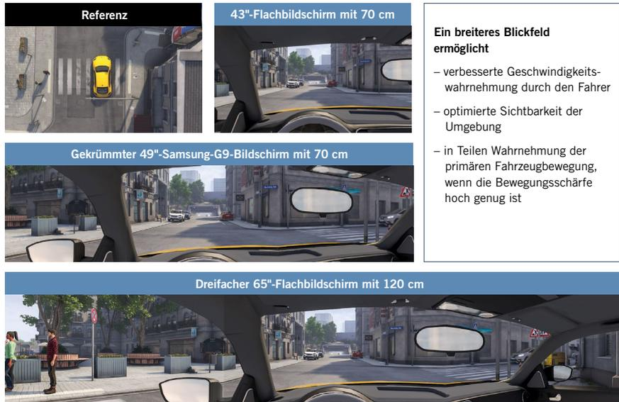
**BILD 3** Unterschiedliche Blickfelder im DiL-Simulator bei verschiedenen Bildschirmdiagonalen (43, 49 und 65 Zoll) und unterschiedlichen Abständen zum Bildschirm (70 und 120 cm) (© IPG Automotive GmbH)
