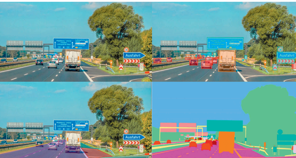
Bild 2: Annotation von Sensor-Rohdaten © b-plus
