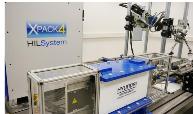
Parametersätze zwischen Prüfstand und Fahrzeug direkt übertragen lassen. Somit erfolgt die Lenkungsabstimmung technisch genauso wie im Auto mit dem Unterschied, dass am Prüfstand direkte objektive Ziele verfolgt werden.
